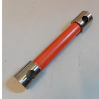
Abbildung 19: Metall/GFK-Hybridprüfkörper mit eingeklebtem Gewindeeinsatz (links) und mit Anbindungselementen für die Zugprüfung (rechts).
