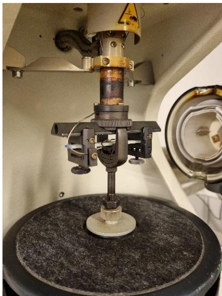
Abbildung 31: Prüfungsanordnungen zur dynamisch-mechanischen Analyse im 3-Punkt-Biegemodus (links) sowie im Torsionsmodus (rechts).
