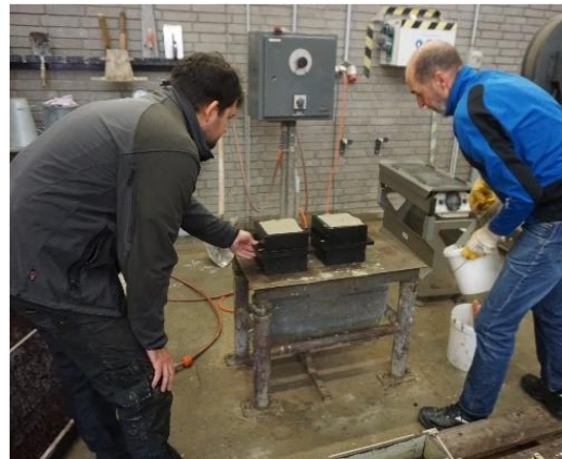
Abbildung 32: Betonage Versuchsgruppen G01 bis G10
