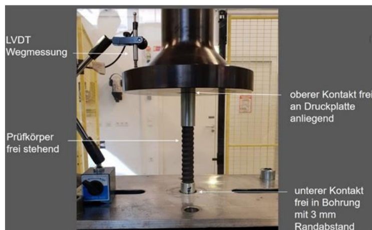
Abbildung 29: Prüfaufbau für Langzeit-Druckprüfungen am Bauteilprüffeld
