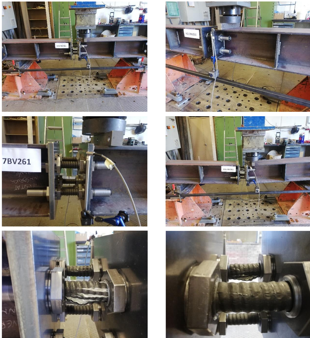
Abbildung 38: Untersuchung Langzeitfestigkeit, Finales Konzept G17
