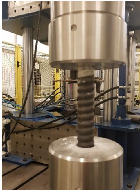
Abbildung 28: Prüfanordnung am Bauteilprüffeld inkl. Adapterstücke zur Einspannung der GFK-Gewindestäbe für Langzeit-Zugprüfungen
