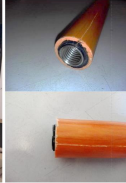
Abbildung 20: Zugprüfanordnung im Labor für Werkstoffkunde und Prüfung der Kunststoffe (links), versagter Prüfkörper nach der Zugprüfung (rechts).
