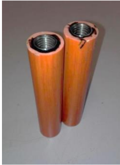
Abbildung 19: Metall/GFK-Hybridprüfkörper mit eingeklebtem Gewindeeinsatz (links) und mit Anbindungselementen für die Zugprüfung (rechts).
