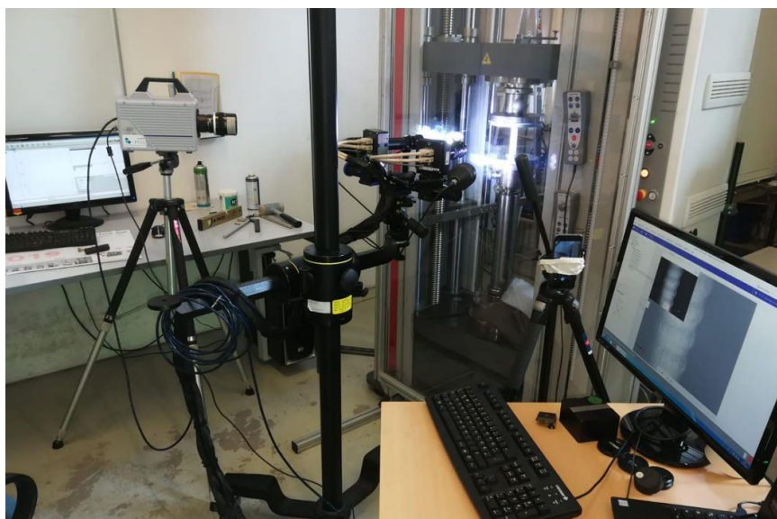
Abbildung 25: Prüfanordnung für Druckversuche mit Messequipment zur Deformations- und Bruchanalyse.
