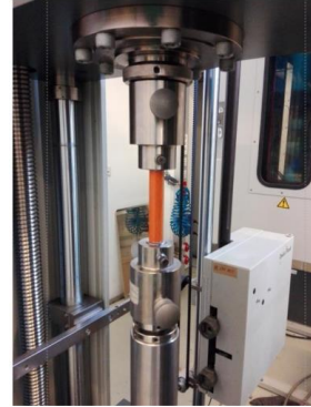
Abbildung 20: Zugprüfanordnung im Labor für Werkstoffkunde und Prüfung der Kunststoffe (links), versagter Prüfkörper nach der Zugprüfung (rechts).
