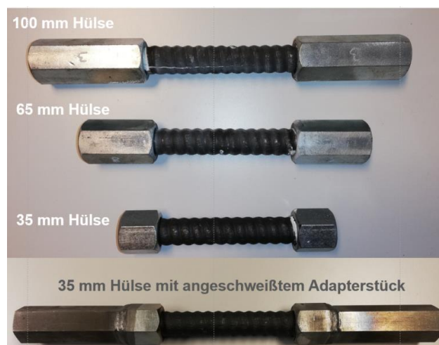
Abbildung 21: Gewindestangen mit unterschiedlichen Metallanbindungen
