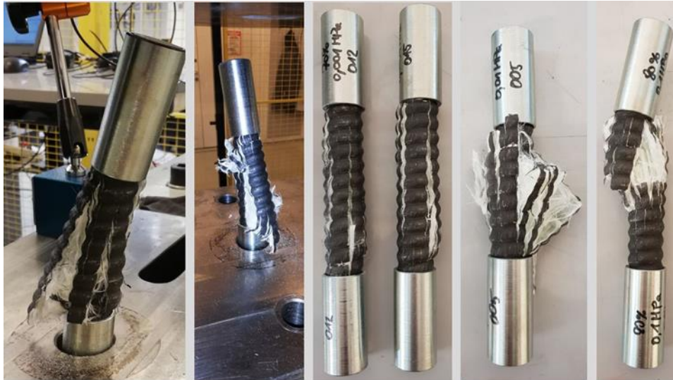
Abbildung 30: Versagensbilder geprüfter GFK-Gewindestäbe nach SRCR-Druckprüfung bei unterschiedlichen Lastniveaus bzw. Lastrampen
